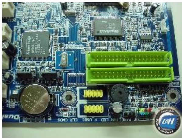
Figura 1: Detalhe das portas IDE extras da placa-mãe Gigabyte GA-SINXP1394.
